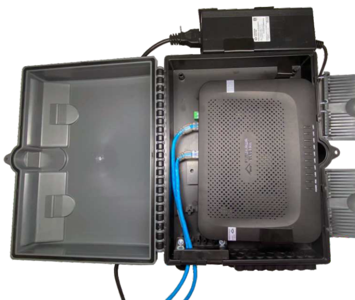
Suporte para fonte com proteção para o plug de energia.
